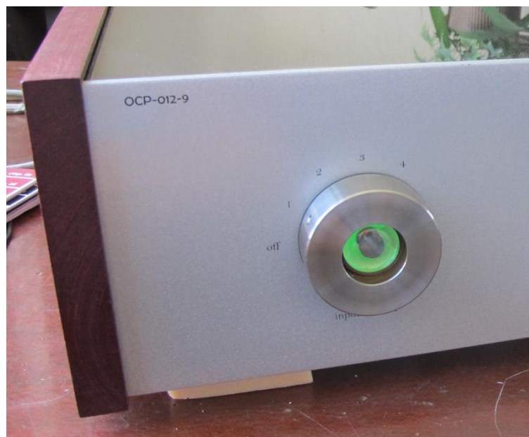
Рис.12 Переключатель входов Asteria (вариант энкодера PS-05-D-02) с встроенным ламповым индикатором уровня звука 6E5C в усилителе «Oriolus».
