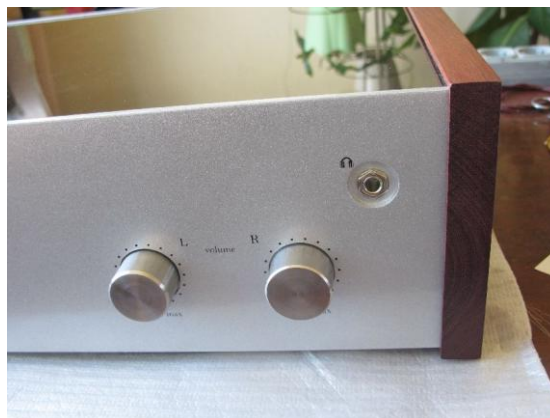
Рис. 4 Фото ручек управления регулятора Rommy V-18-D-01 на передней панели усилителя
